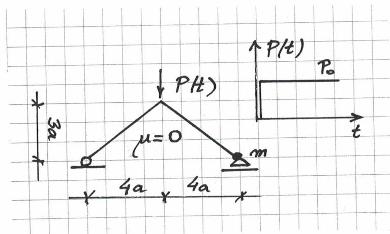
Zadanie 2 Dana belka o gęstości masy  $\mu$  z masą skupioną  $m$  w środku jest poddana danemu obciążeniu harmonicznemu. Obliczyć amplitudę reakcji pionowej w utwierdzeniu A.
