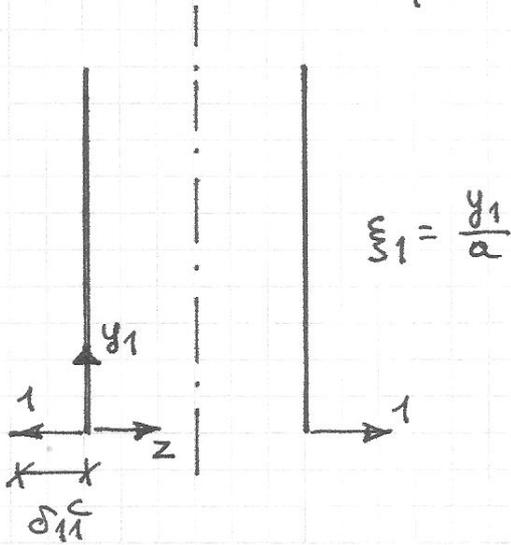
Rozpatrujemy zaburzenie na dolnej krawedzi. Zaburzenie na górnej krawedzi wywołuje efekt symetryczny.
